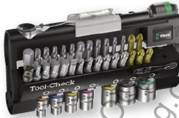
28 Bits, 1 Rapidaptor-Bit-Halter, 1 Adapter 870/1 (1/4"-Sechskant auf 1/4"-Vierkant), 7 Nüsse (1/4"). 1 Wera-Bit-Ratsche, gesenkgeschmiedete Vollstahlausführung; geeignet für die Aufnahme von Bits mit 1/4"-Außensechskantantrieb nach DIN ISO 1173-C 6,3 und E 6,3 und Wera Anschluss-Reihen 1 und 4; über Adaptierung mit Wera Adapter 870/1 ist auch der Einsatz von 1/4"-Nüssen möglich
